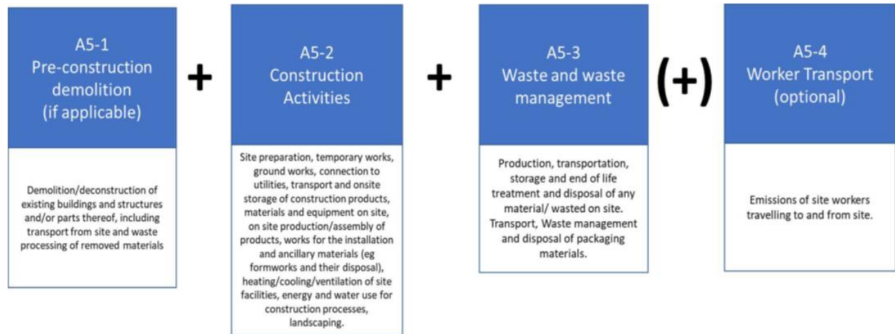
Figure 13: Sub-modules of module A5
